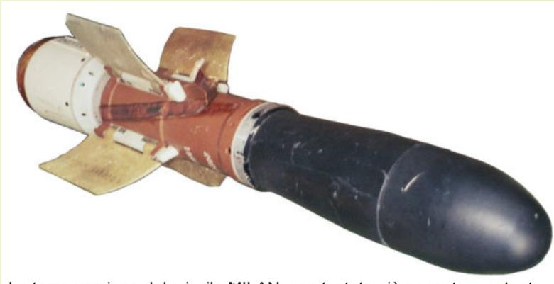
La terza versione del missile MILAN, con testata più pesante e potente, e senza la caratteristica sonda appuntita.
