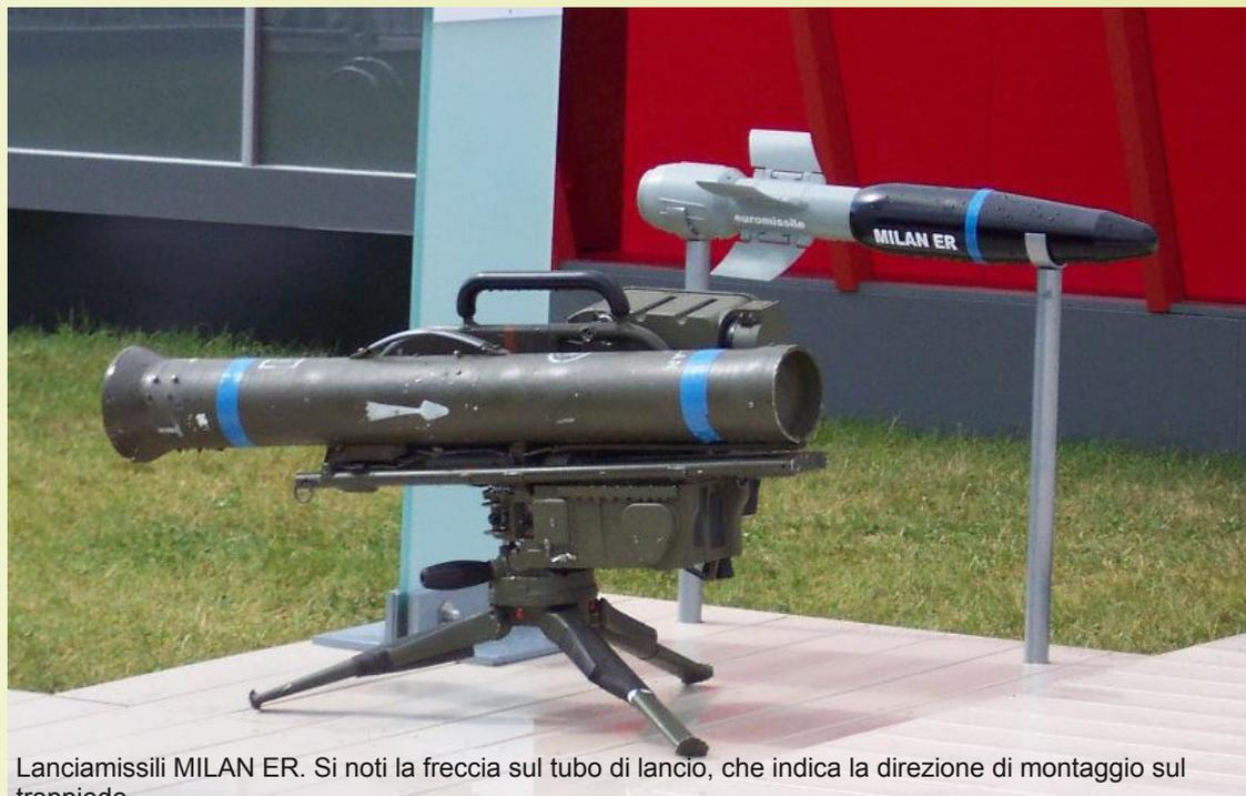
Lanciamissili MILAN ER. Si noti la freccia sul tubo di lancio, che indica la direzione di montaggio sul treppiede.
